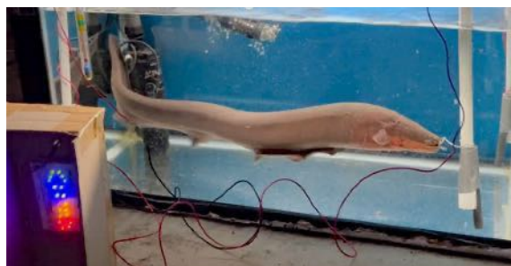
飼育下での放電実験。エサに食いつく際に放電しており、発光ダイオードが点灯する。
